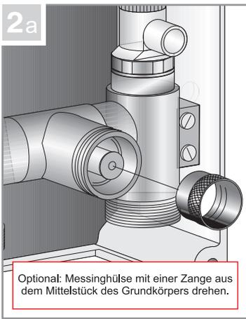
Optional: Messinghülse mit einer Zange aus dem Mittelstück des Grundkörpers drehen.
