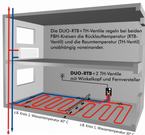
**Bitte beachten Sie, dass bei 2 unterschiedlich temperierten Heizkreisen eine Dehnungsfuge berücksichtigt werden muss!**
