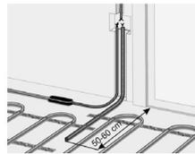
Die Fühlerleitung des Thermostats muss in einem **separaten Leerrohr** nach EN 61386-1 verlegt werden. Der Fühler muss unmittelbar unter der Heizmatte positioniert werden, indem ein Schlitz im Boden aufgestemmt und das Leerrohr darin versenkt wird. Der Fühler sollte mittig zwischen zwei Heizleitern positioniert werden, also in der Mitte einer Heizkabelschleife.
